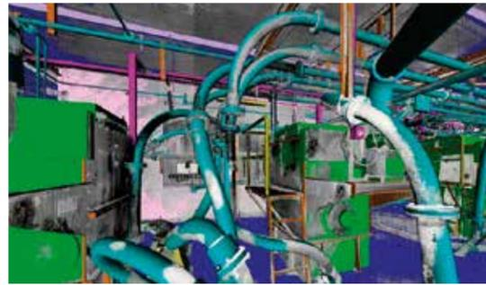
Neuprojektierung Rohrleitung mit Kollisionsprüfung
